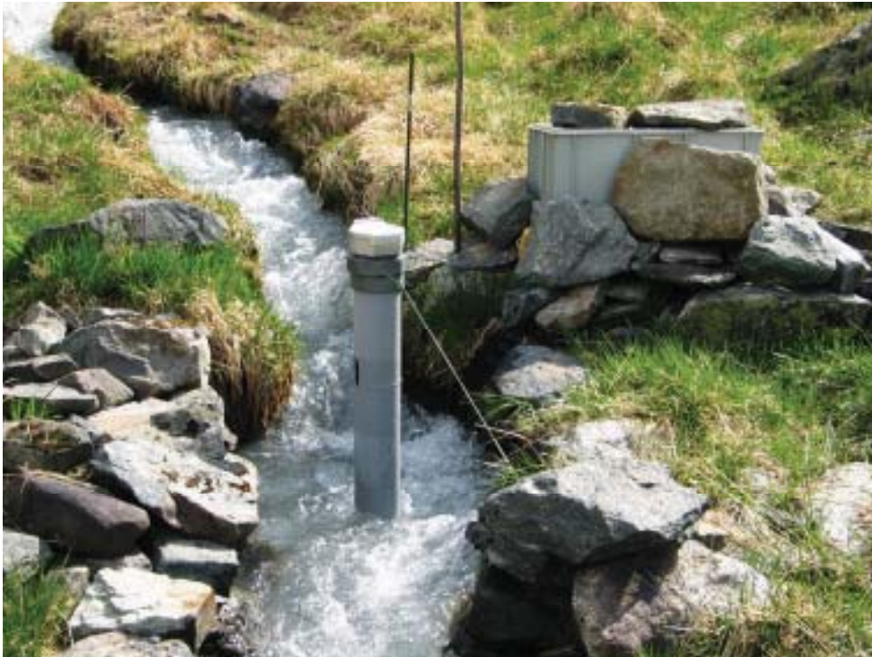
Abb. 6: Automatische Pegelstation ca. 30 m unterhalb der Stirn des Blockgletschers im Inneren Reichenkar, ausgestattet mit einer Druckpegelsonde und einem Temperaturfühler (Micro von Logotronic).
